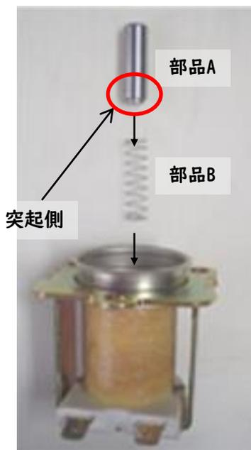
3. 新品の電磁弁から同じようにネジで止められている部分を取り外してください。
