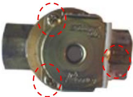
1. プラスドライバーでネジを取り外します。
