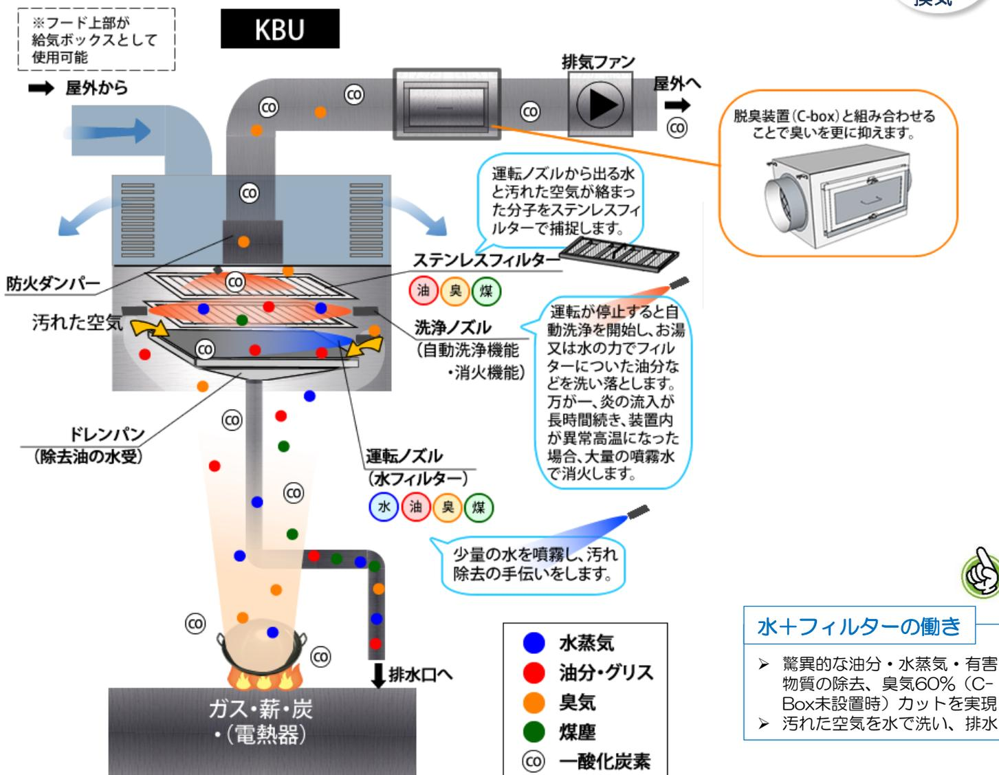
※定期メンテナンス(フィルター・ドレンパン・フード側面の洗浄・消耗部品の交換)が必要になります
