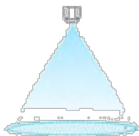
噴霧口が磨耗した噴霧ノズル
