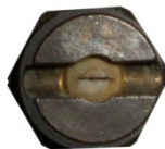
噴霧口が磨耗した噴霧ノズル
